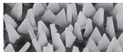
Оптимальное расположение абразивного зерна VICTOGRAIN
