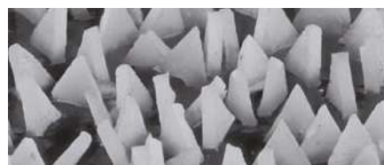
Оптимальное расположение абразивного зерна VICTOGRAIN
