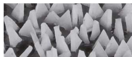
Оптимальное расположение абразивного зерна VICTOGRAIN
